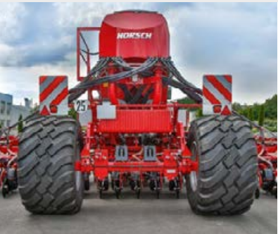
Opzione: pneumatici 710/50–26.5 per la massima superficie di contatto
