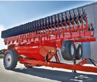
Pneumatici di grandi dimensioni del carrello Avatar 18.25 SD: 520/85 R 42
