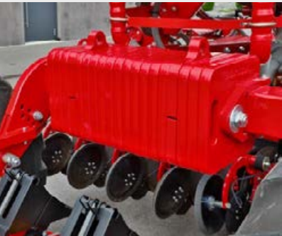
Pesi supplementari opzionali per poter generare una maggiore pressione del vomere
