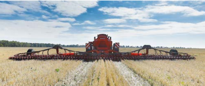
Trasmissione idraulica del peso dal carrello al telaio dei vomeri: Elevate e uniforme pressione dei vomeri sull'intera larghezza di lavoro.
