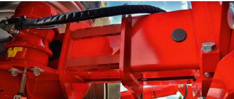
Asse telescopico di serie Larghezza di trasporto compatta, riduzione del carico dietro la traccia del trattore
