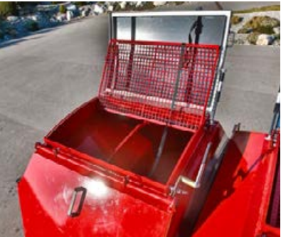
Terzo serbatoio opzionale della capacità di 2 400 l per Avatar 18.25 SD
