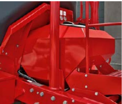
Terzo componente per Avatar 12.25 SD con capacità di 390 litri
